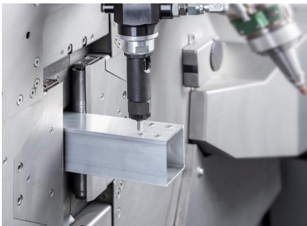
La sorgente laser in fibra consente ampia manovrabilità su spessori e materiali diversi, si va dai 12 mm di acciaio dolce ai 4 mm di ottone. La lavorazione 3D completa il quadro di un sistema estremamente flessibile e capace di spaziare fra le più svariate applicazioni.
