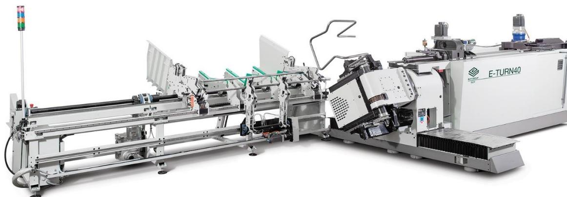
La soluzione esposta in fiera, ideale per la produzione non presidiata, aggiunge alla curvatubi E-TURN il sistema di carico automatico dei tubi da fascio e il robot per lo scarico dei tubi curvati.
